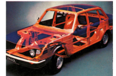
Säkerhetsbur av kraftiga stålprofiler med välberäknade deformationszoner fram och bak ger de åkande maximalt skydd vid en eventuell kollision.
