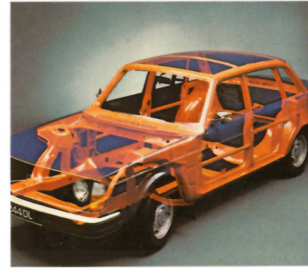
Säkerhetbur av kraftiga stålprofiler, sidokrocksskydd i dörrarna och välberäknade deformationszoner fram och bak ger de åkande maximalt skydd vid en eventuell kollision.
