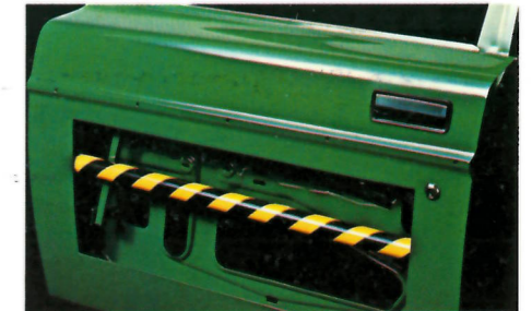
Rörförstärkning i dörrarna är en del av säkerhetskarossen. Skyddar de åkande vid påkörning från sidan.
