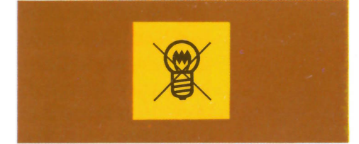
Glödtråden slår larm om halv-, broms- eller helljus faller ur funktion.
