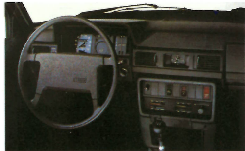
Mjukmadrasserad instrumentpanel med effektiva luftinsläpp. Rattvinkel på 23° ger bekväm körställning och gör det lättare att komma i och ur.
