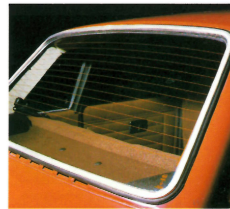
Den eluppvärmda bakrutan tar effektivt hand om imma och frost.
